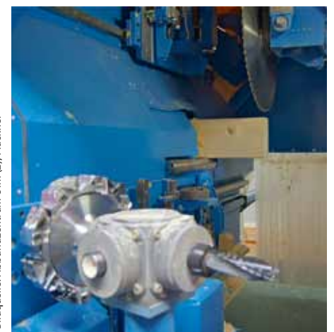
Schnell, präzise und flexibel: Schwenkkappsäge und Revolverfräse im der Speedcut SC3
