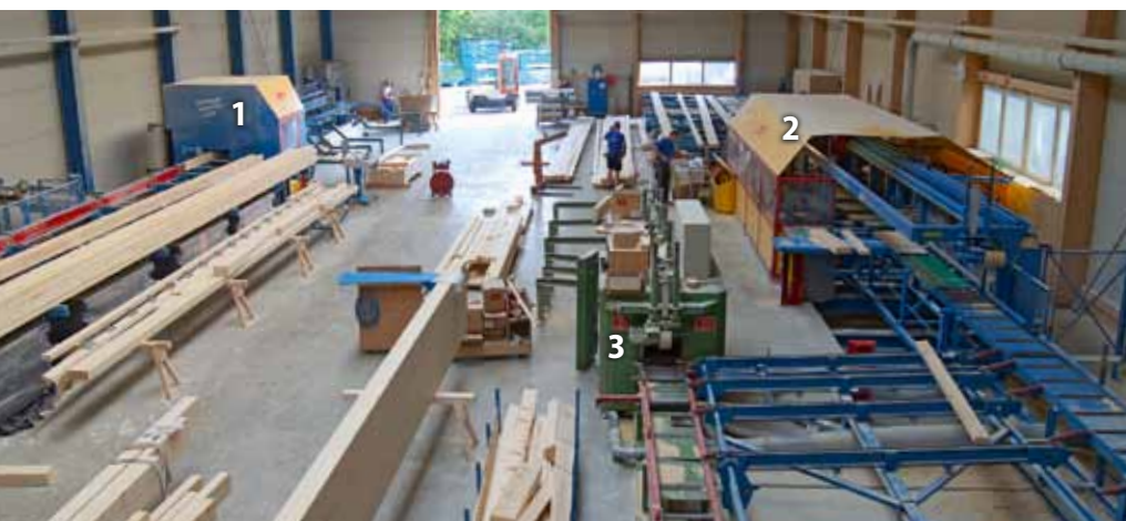
In der Werkshalle des Abbundzentrum Ulm arbeitet seit einem Jahr eine Speedcut-SC3 (1), seit 2006 eine K2i (2) und seit den Betriebsbeginn 1991 ein Vierseiten-Hobelautomat (3) – alles von Hundegger
